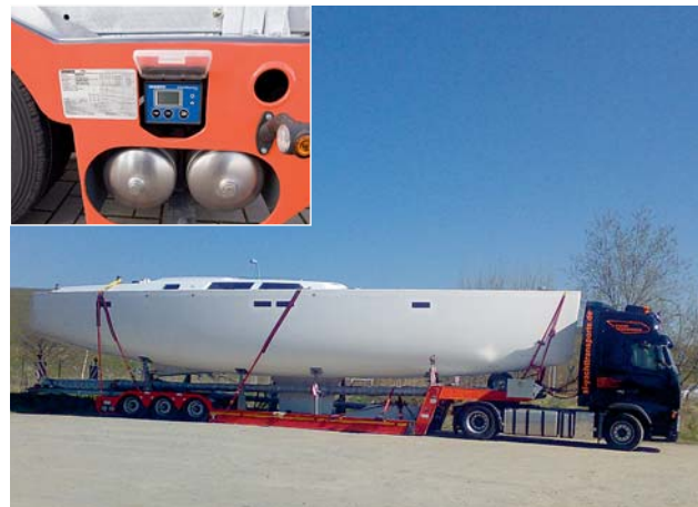
Der Bootsanhänger ist mit der Premiumversion des WABCO Trailer EBS E ausgerüstet
